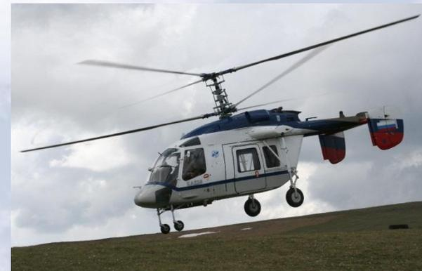
Вертолет Ка-226Т является ремоторизованным (с двигателями Turbomeca Arrius 2G1) вариантом серийно выпускаемого вертолета Ка-226 и новым комплексом бортового оборудования. Первыми заказчиками вертолета стали авиация МЧС РФ и ОАО «Газпром».
